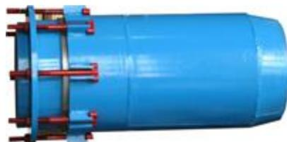
Компенсаторы односторонние предназначены для компенсации температурных расширений в трубопроводах тепловых сетей Ду 100 ..... 700 мм с параметрами  $P_y \leq 2,5 \text{ МПа}$  ( $25 \text{ кгс/см}^2$ ) и  $t \leq 200^\circ\text{C}$ .
