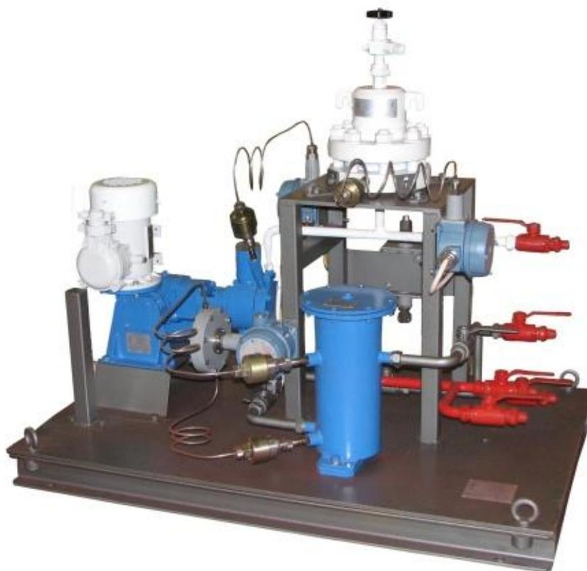
Установки электронасосные дозирочные УНД1М предназначены для объёмного дозирования токсичных, агрессивных, взрывоопасных, горючих и легковоспламеняющихся жидкостей с температурой от 233К до 353К (от минус 40 °С до +80 °С), кинематической вязкостью не более  $8 \times 10^{-4}$  м<sup>2</sup>/с, и не вызывающих химического разрушения материалов проточной части из сталей 10Х17Н13М2Т, 12Х18Н9Т ГОСТ5632-72 (метанол), стали 20 ГОСТ1050-88 (метанольная вода и др.), стали 09Г2С ГОСТ 19281-89.
